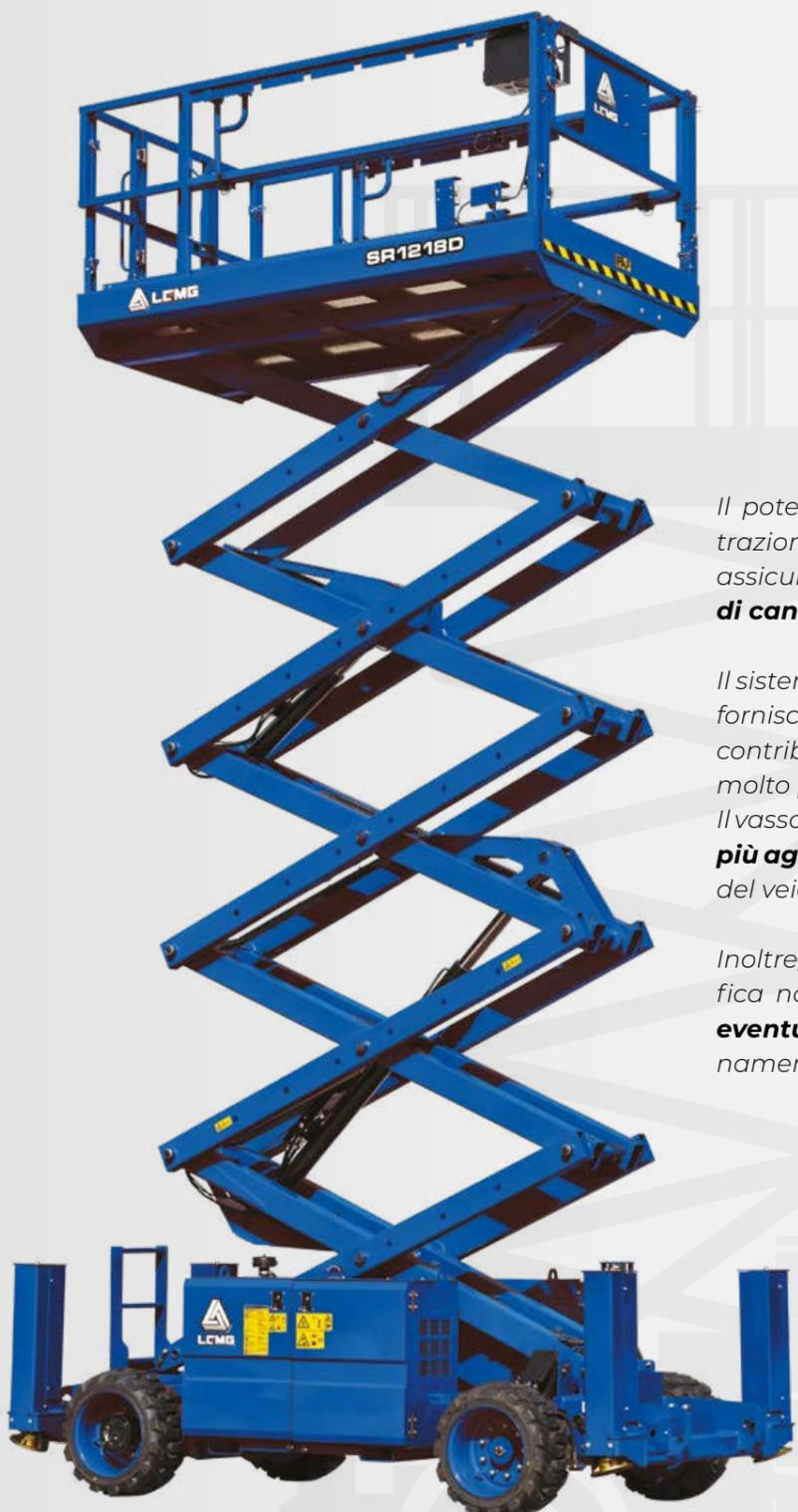
Il potente motore diesel, gli assali oscillanti e la trazione integrale collaborano sinergicamente per assicurare **elevate prestazioni su quasi tutti i tipi di cantieri**, specialmente su terreni accidentati.
